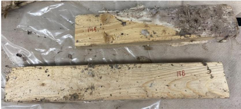
Figure 4 Figure 3.1 Latte de mur recouverte par la mэрule pleureuse (haut de l'image) et non contaminée (bas de l'image)
